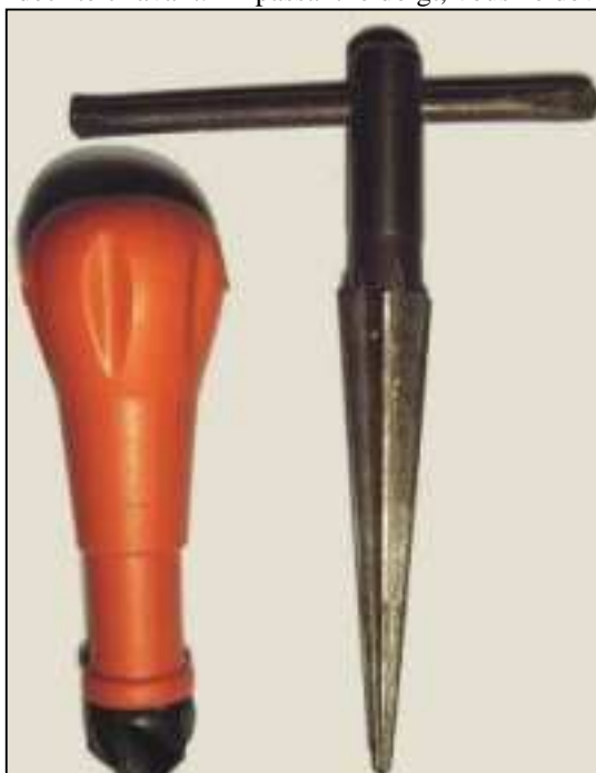
A gauche, une fraise à 90°. A droite, un alésoir.
