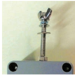
Vijsbevestiging van draad en plaatje
