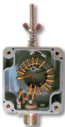
Vervaardiging trafo Construction du transfo
