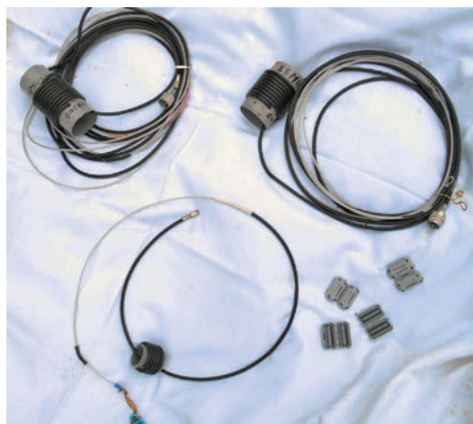
Foto 1. Drie Glupti prototypes. De choke baluns zijn 'op lucht' gewikkeld. Deze met behulp van ferrietkernen presteren beter: geen parasitaire capaciteit, hogere reactantie, minder windlast, geen geplooid coax, en gemakkelijk verplaatsbaar.
