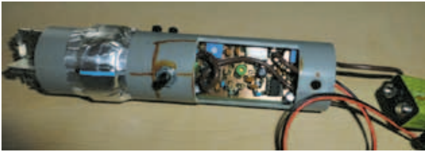
Foto 2. Dubbelzijdig afgeschermd 80m ontvangstspool met links ervan de elektrische antenne
