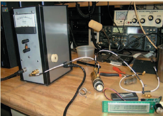
Fig. 39. Referentiemetingen in labo van ON8DC. Uit proeven in het labo van ON8DC blijkt dat de Si570 uitermate geschikt is als generator.
