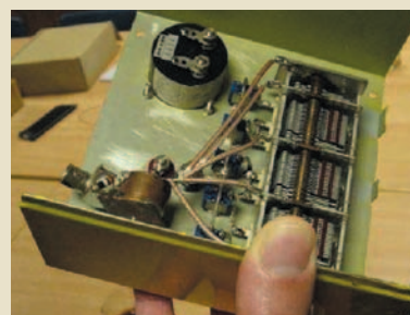
Fig. 34. Mechanische opstelling eerste prototype ON4CHE (april 2009). Vastgestelde fouten: de aansluitingen van de warme kant van de spoel moeten 2,5 cm van de omgeving verwijderd zijn; er moet een goed geleidende behuizing (bvb. printplaat i.p.v. ijzer) gebruikt worden.
