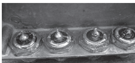
Fig. 2. Met 1208-weerstandjes van 100 Ω (notatie: 101) geraak je al een eind weg. Er zijn veel mogelijke combinaties om de connector af te sluiten met 200/100/50/25 Ω. Vertinnen, SMD positioneren, voorzichtig aan één kant solderen, eventueel de positie wat corrigeren, de andere zijde solderen en opnieuw aan de eerste zijde het soldeertin mooi laten vloeien.
