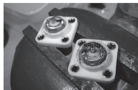
Fig. 3. Soldeerbout van ca. 50 W, loep gebruiken en vooral bevende vingers vermijden.
