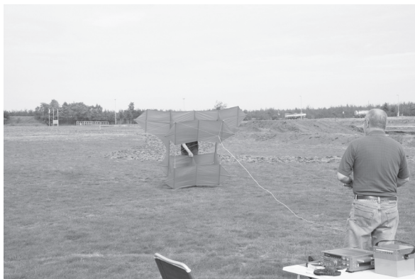
Fig. 3 La station Radio et le cerf-volant prêt pour le lancement. La ligne du cerf-volant est presque invisible. Le gros fil blanc attaché au cerf-volant est l'antenne demi-onde sur 3,65 MHz.
