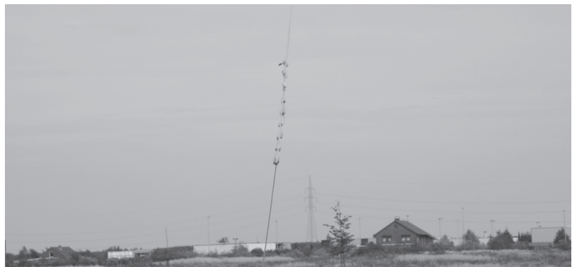
Fig. 5 La ligne d'alimentation (partie supérieure). Le stub est replié et maintenu par des élastiques et des écarteurs à la ligne d'alimentation (partie médiane). La dernière partie en noir est le coax vers la station.
