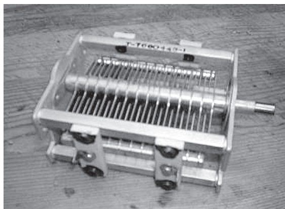
Fig. 1 Een klassieke hoogspannings CV. Gemonteerd op steatiet dragers. De elementen bestaan uit messing en vertind staal. Afkomstig van de Amerikaanse tuning units uit de laatste oorlog. Foto Marco Thues ON3TM. Zie tekst voor meer informatie.
