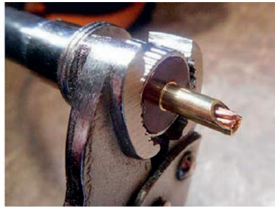
De plug met een griptang over de kabel schroeven en de coaxkern vast solderen. Visser avec une pince Grip et souder l'âme.
