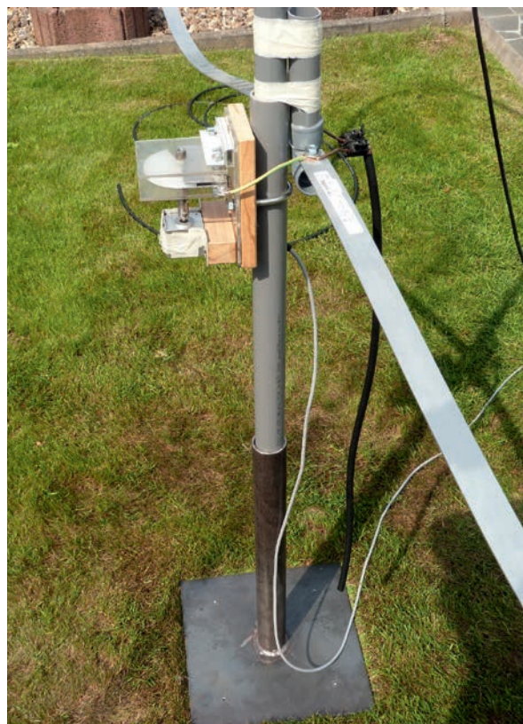
Foto 1: Coax als vaste condensator
