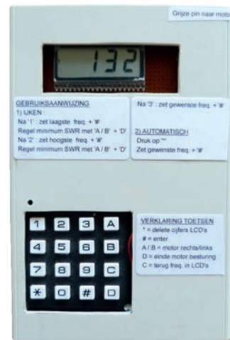
Foto 3: Apparaat om condensator automatisch te tunen
