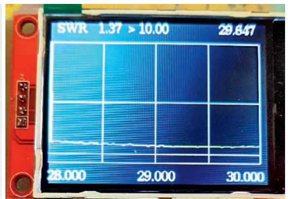
Fig. 2 Voorbeeld van het scherm van de antenneanalyzer met het meetresultaat van een 10m-antenne
