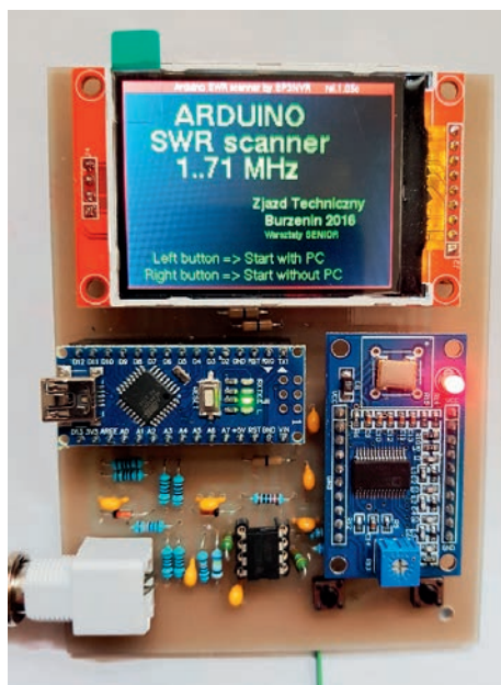
Fig. 3 De antenneanalyzer van Waldemar SP3NYR met uitbreiding tot 71 MHz
