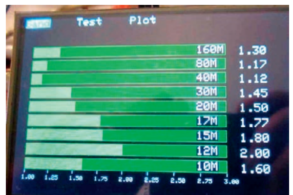
Fig. 8 Display met een overzicht van alle minimum SWR-waarden per band
