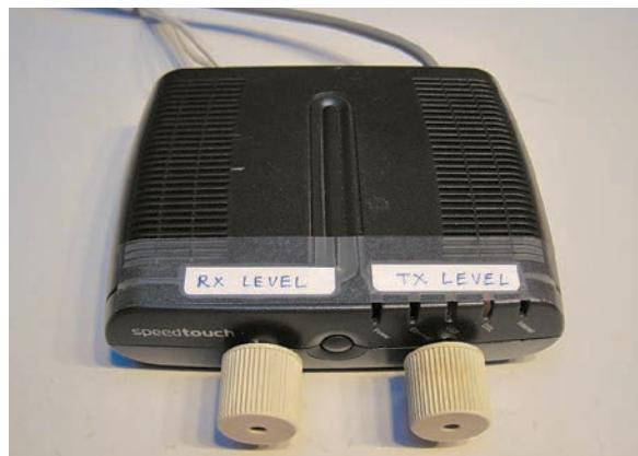
Au fond à gauche on voit les deux connexions audio vers le PC (line-in et line-out), à droite le câble (récupéré sur le clavier) vers le transceiver. Tous les cordons ont été fixés par des colliers Colson.
