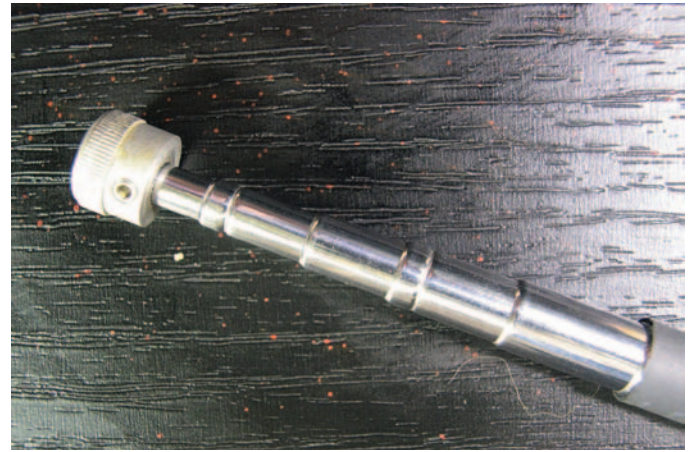
Fig. 7: détail du "bouton" d'extrémité réalisé avec un bouton en alu pour axe de 4mm.
