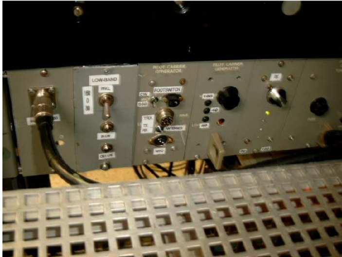
De Low Band module in een 19" rack
